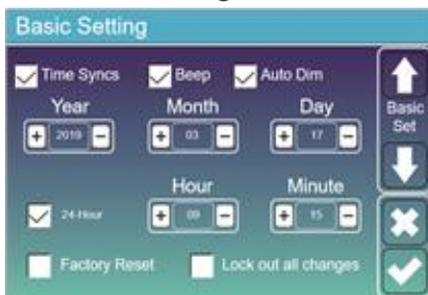
**Factory Reset:** Resettare tutti i parametri dell'inverter.
